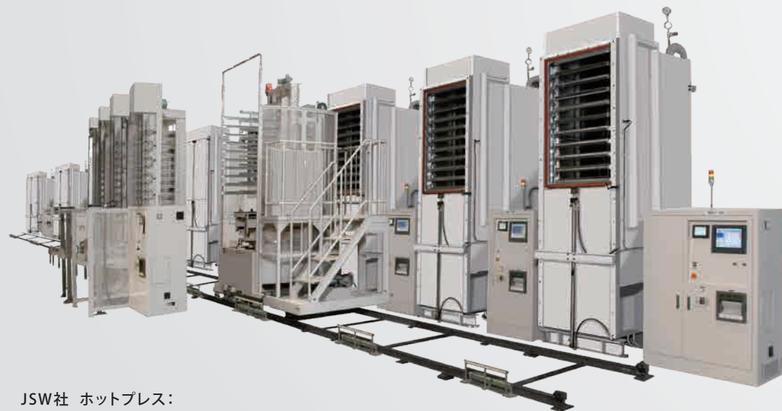
JSW社 ラミネータ： 真空化で製品全面に均一に フィルムを貼り合わせる装置。
