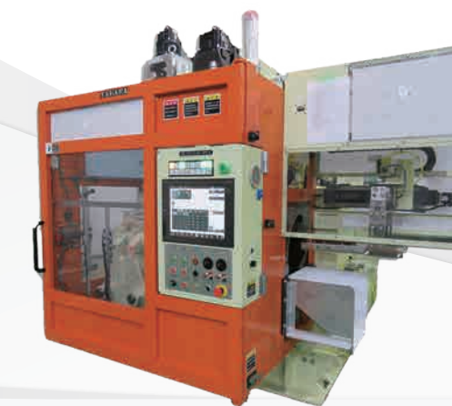
タハラ社 電動ブロー成形機： 全電動化されたことにより、クリーン運転・省エネ・ 高サイクル・高品質成形などの特長があります。ダ ブルステーション化・システム化への発展、レベル アップが望めます。
